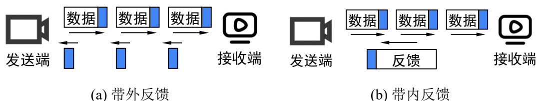
图 4.7 带内反馈与带外反馈的示意图
